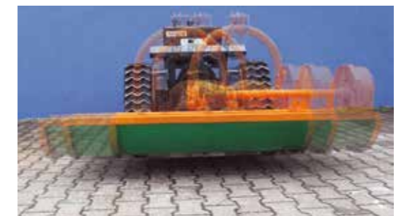
40 cm Seitenverschiebung zum echten randnahen Arbeiten an Zäunen, Treppen und Mauern.
