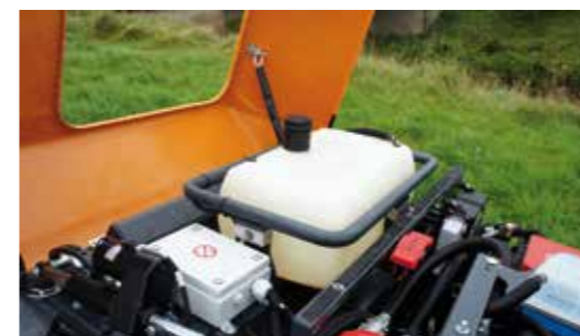
30 Liter fassender Tank mit Reservefunktion für mindestens 6 Stunden Arbeit ohne aufzutanken.
