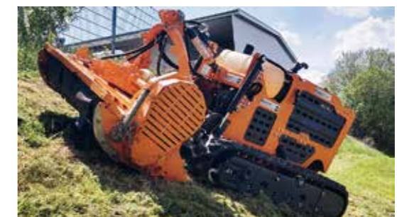
Mulcher zum Vorbereiten von Flächen für die Bodenbearbeitung z.B. zur Grundräumung von Gestrüpp.
