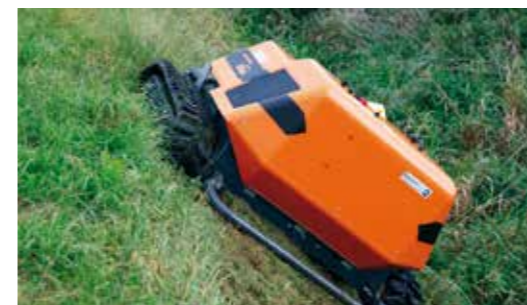
Stufenlose Einstellung der Schnitthöhe über die Fernsteuerung. Ein Rammbügel schützt das System vorne und hinten.
