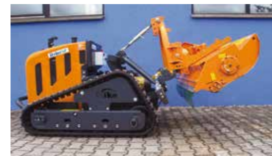
Der Kraftheber verfügt über eine extrem hohe Aushebung mit einer Hubkraft von bis zu 450 kg.
