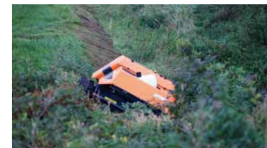
Breit, flach, stark. - Und dennoch mit wassergekühltem 3 Zylinder Dieselmotor mit 25 PS.
