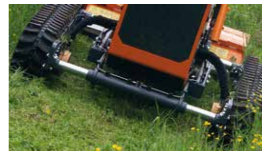
Spurbreiterung des Fahrwerks von 133 cm bis 175 für mehr Traktion.
