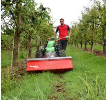
Rapid Schlegelmulcher schneiden und häckseln Gräser wie Jungwuchs fein und legen das Mulchgut sauber ab. Die auf der ausgewuchteten Welle beweglich gelagerten und extrem widerstandsfähigen Y-Messer ermöglichen ein vibrationsarmes Arbeiten bei höchster Effizienz. Resultat ist ein sauberes Schnittbild auf perfekt gepflegten Grünflächen.
