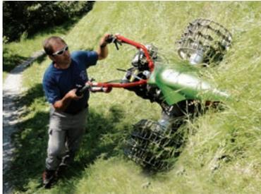
Mit dem Rapid Rex arbeiten Sie auch dort effizient, wo bisher nur Sensen im Einsatz waren. Dank nur 85 kg Gewicht und tiefem Schwerpunkt lassen sich Hanglagen bis zu 120% Gefälle sicher bearbeiten. Mit der aktiven Holmlenkung ist präzises Manövrieren selbst in unwegsamem Gelände einfach und sicher.
