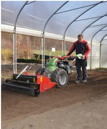
Mit der Umkehrfräse werden Altrasen, Pflanzenreste und Steine nach unten in den Boden eingearbeitet. Schon nach einem Arbeitsgang liegt die feine Erde obenauf. Steine einsammeln entfällt, der Zeitgewinn bei der Bodenbearbeitung ist eindrucklich.
