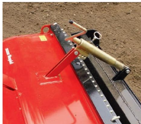
Mittels Spindel stufenlos einstellbare Bearbeitungstiefe
