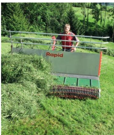
Der Rapid Multi-Twister verfügt über ein Förderband, mit dem das Erntegut nach der Aufnahme durch den bewährten Pick-up aktiv zur Seite abtransportiert wird. Daher sind Einsätze am Hang und in der Ebene möglich. Darüber hinaus vergrößert der aktive Abtransport das Einsatzspektrum hinsichtlich Grünfutter und Silage. Ebenso ermöglicht das Förderband verfahrenstechnisch den Arbeitsgang «Schwaden».
