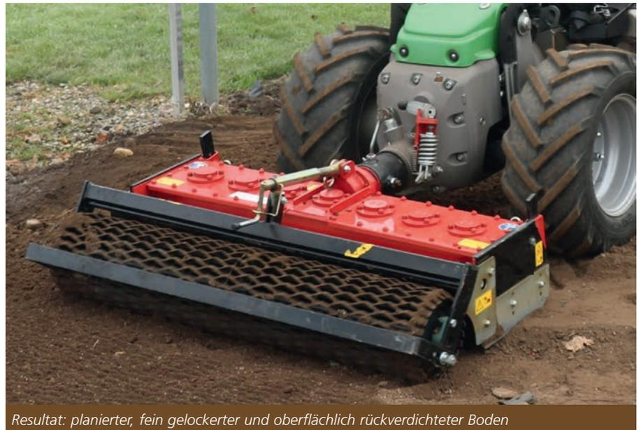
Resultat: planierter, fein gelockerter und oberflächlich rückverdichteter Boden
