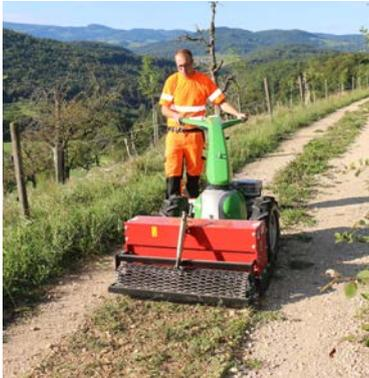
Mit dem Wegepflegegerät werden wassergebundene Flächen, wie z.B. Schotter-, Splitt- und Kieswege/-plätze, einfach, schnell und ökologisch wie ökonomisch sinnvoll gepflegt. Pflanzen werden mittels mechanischer Bewegungen entwurzelt und auf der Oberfläche abgelegt, wo sie einfach entfernt werden können. Dank der variablen Arbeitshöheneinstellung bleibt die Bodenschichtstruktur unbeschädigt. Bearbeitete Flächen erstrahlen so ohne Einsatz von chemischen Stoffen in einem sauberen, gepflegten Bild.
