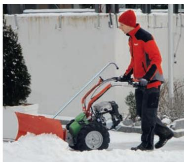
Rapid Räumschilde zeichnen sich durch ihre Vielseitigkeit, Sicherheit und einfache Bedienung aus. Mit dem vom Holm aus bequem bedienbaren Schwenkmechanismus wird Schnee effizient in die gewünschte Richtung weggeschoben. Dank werkzeuglos montierbaren Seitenblechen ist rückstandsloses Räumen von grösseren Flächen möglich.
