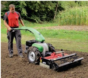
Mit der Uni-Kreiselegge werden Erdschollen wirkungsvoll zerkleinert, das Erdreich gelockert, mit Sauerstoff versehen und fein planiert. Auf Grund der hohen Kreiselzinkenzahl wird bereits in einem Arbeitsgang ein feiner Zustand des Bodens erzeugt. Dieser bildet die perfekte Grundlage zum erfolgreichen Anbau von verschiedensten Pflanzen, Gemüse oder Rasen.
