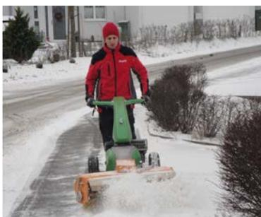
Die leistungsfähigen Rapid Geräte zum Kehren lassen sich flexibel und ganzjährig einsetzen. Im Sommer werden Staub und Schmutz beseitigt, während im Winter frisch verschneite Beläge schwarz gekehrt werden. Es besteht die Möglichkeit in Fahrtrichtung oder seitlich wegzukehren. Wird der Schmutzsammelbehälter montiert, lässt sich im selben Arbeitsgang der Schmutz sauber aufnehmen. Kommt der Seitenbesen zum Einsatz, wird Sauberkeit bis an Hindernisse wie z.B. Randsteine spielend einfach erreicht.
