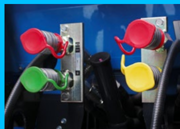
4 farblich gekennzeichnete Hydraulikanschlüsse der 2 serienmäßigen Steuerkreise
