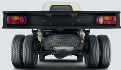
Mit seinem verstärkten Chassis und den Zwillingshinterrädern bietet der Porter Maxi mehr Ladekapazität und größere Stabilität, auch bei voller Beladung. Der Porter Maxi ist mit einem begrenzten Sperrdifferential für spursichere Traktion, auch unter härtesten Bedingungen, ausgestattet.
