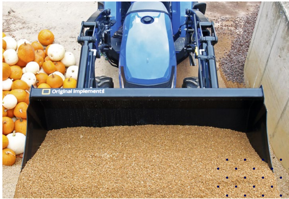
Großvolumige Schaufelkörper erlauben auch die Aufnahme großer Mengen Schüttgüter in einem Arbeitsschritt.
