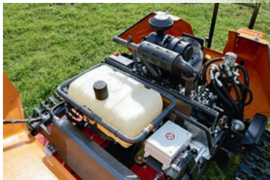
Der Überrollschutz und die Abdeckhauben können bequem hochgeklappt werden, um Zugang zu allen wichtigen Komponenten zu erhalten.
